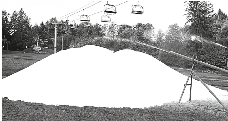
Technologie Snowfactory vyrábí sněh, který je bez jakýchkoliv chemických přísad a je založený pouze na dvou hlavních zdrojích – vodě a vzduchu. Ilustr. foto Areál Monínece
